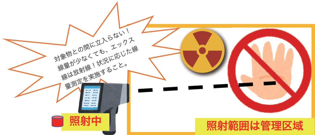
図3 ハンディタイプ蛍光エックス線装置使用時の注意事項
