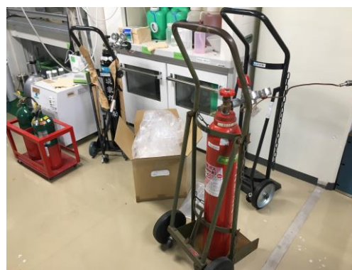
可燃性ガス(水素)と支燃性ガス(酸素)が近い
