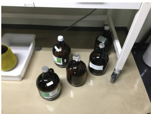
有機溶剤の入ったガロン瓶が、蓋がされていない
