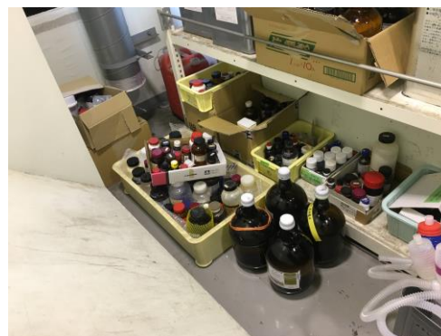
危険物倉庫の通路に薬品が積みあがった状態
