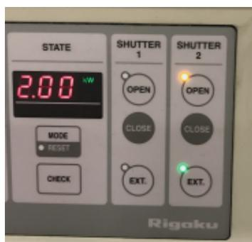
図5 装置制御板上の表示
