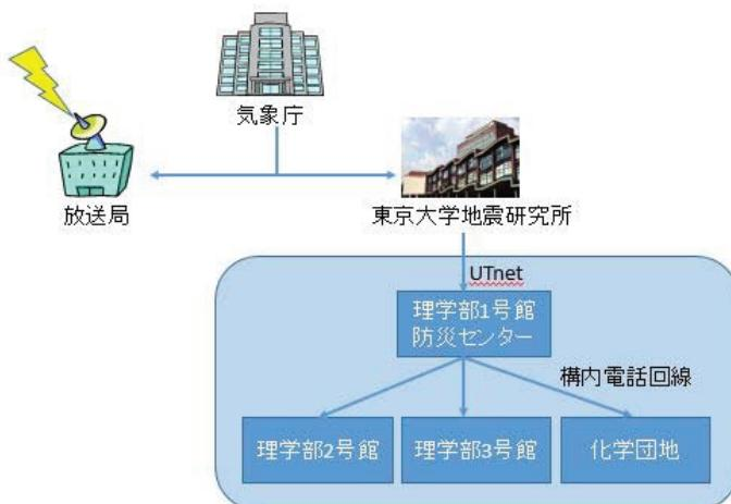
図9 緊急地震速報の伝達経路
